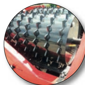
Rullo con creste saldate con tubo 500x10
