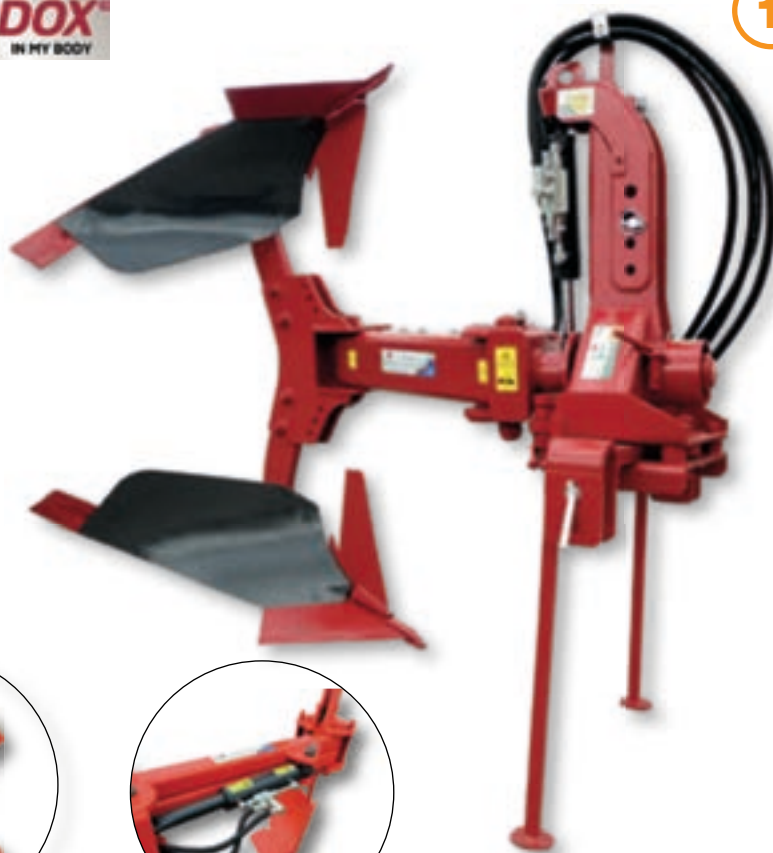
Spostamento laterale idraulico
