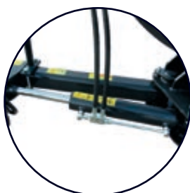
Regolazione idraulica del timone per spostarlo lateralmente
