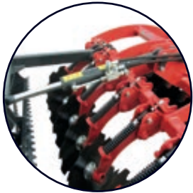
Regolazione idraulica del rullo
