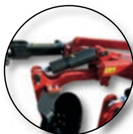
Sicurezza con molla a compressione a carico variabile
